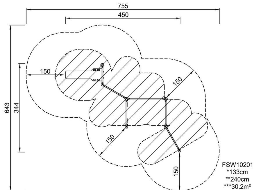
\* Hauteur de chute maximale | \*\* Hauteur totale
