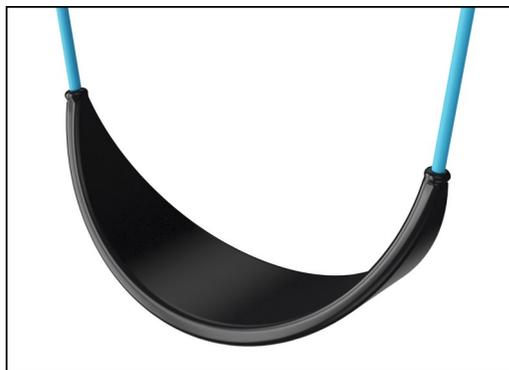
Der Schaukelsitz ist aus UV-stabilisiertem PUR gefertigt. Es behält seine Eigenschaften im Temperaturbereich von -30°C bis 60°C. Die Seile bestehen aus UV-stabilisiertem PP-Seil mit innerer Stahlseilverstärkung und Außenschicht aus transparentem PUR.
