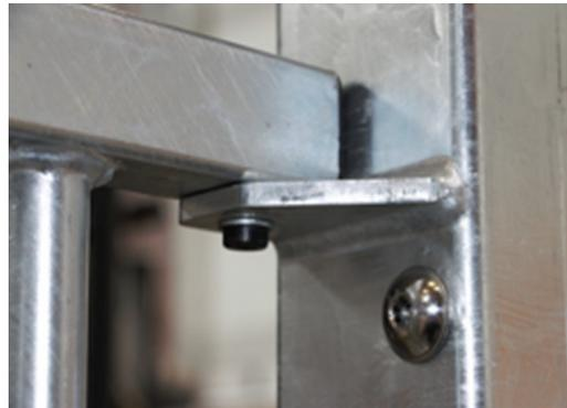
Alle Stahl Komponenten werden aus Karbonstahl gefertigt, geschweißt nach EN ISO 5817 und feuerverzinkt nach ISO 1461. Dieser Prozess gewährleistet eine lange Lebensdauer in allen Umgebungen.
