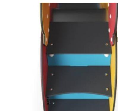
Gli step sono realizzati in laminato HPL ad alta pressione con spessore 17,8 mm e struttura superficiale antiscivolo secondo EN 438-6. KOMPAN HPL ha un'elevata resistenza all'usura per garantire una lunga durata in tutti i climi.
