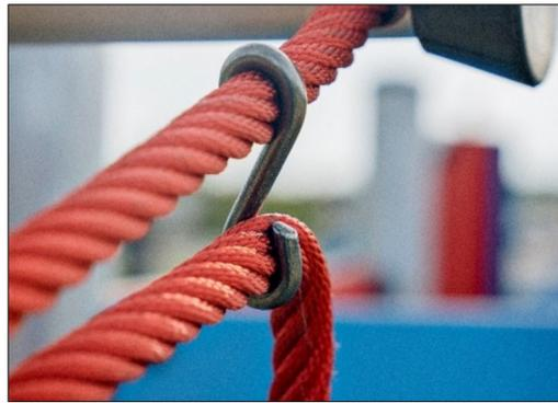
Corocord“S”扣在 Corocord 产品中作为通用连接。用特殊的液压机将带有圆形边缘的 8mm 不锈钢条压在绳索周围，使其成为理想的连接部件。其安全、耐用且防破坏，适用于攀爬网游戏中的典型游戏运动。
