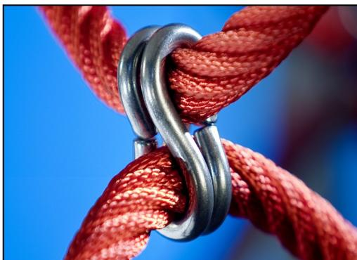
Corocord“S”扣在 Corocord 产品中作为通用连接。用特殊的液压机将带有圆形边缘的 8mm 不锈钢条压在绳索周围，使其成为理想的连接部件。其安全、耐用且防破坏，适用于攀爬网络游戏结构中的典型游戏运动。
