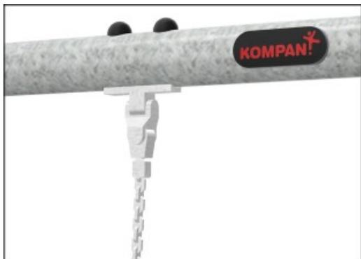
KOMPAN Schwerlast-Schaukelauflösungen aus rostfreiem Stahl mit Verdrehsicherung. Die Aufhängungen sind mit zwei Bolzen am Querträger auf einer geschweißten Halterung befestigt. Die Lager sind mit Silikonschmiermittel versehen und benötigen keine weitere Schmierung.
