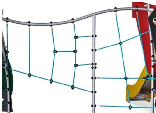
Las redes de escalada están hechas de cuerda de PP estabilizada contra los rayos UV con refuerzo interno de cable de acero. El cable está tratado por inducción para obtener la máxima fijación entre el acero y el cable, lo que proporciona una excelente resistencia al desgaste. Todos los conectores de cable están hechos de material PA 100% reciclable.
