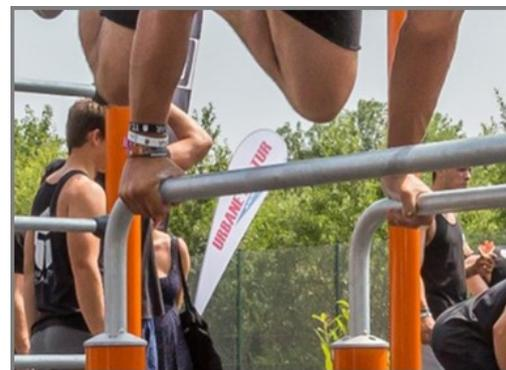
Die Stangen, die als Griffe für Übungen gedacht sind, bestehen aus feuerverzinktem Stahl mit einem Durchmesser von 38 mm. Ein geeigneter Durchmesser um die Handgelenke bei Dips oder Handständen zu unterstützen.
