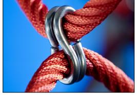
Les crochets en « S » de Corocord sont universellement utilisés dans les produits Corocord. Les tiges en acier inoxydable de 8 mm avec bords arrondis sont pressées autour des cordes avec une pince hydraulique spéciale, ce qui en fait le connecteur idéal : sûr, durable et antivandalisme, tout en permettant le mouvement typique des structures ludiques à cordes.
