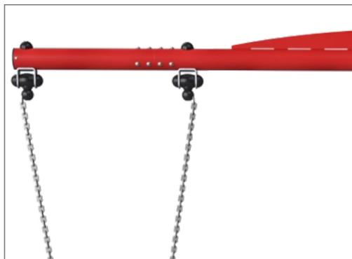
Los colgadores de los asientos están hechos de una carcasa de nailon estabilizado a los rayos ultravioleta (PA6) de alta calidad con rodamientos de bolas sellados de por vida integrados. Las cadenas están fijadas por un gancho de acero inoxidable con perno de ojo de serpiente a prueba de robo en una carcasa giratoria antivuelco.
