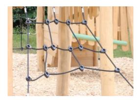
Seile aus UV-stabilisierten PES-Seilsträngen mit innerer Stahlseilverstärkung. Das Polyestergarn wird aus +95 % Post-Consumer-Materialien hergestellt und induktiv auf jede Litze aufgeschmolzen.
