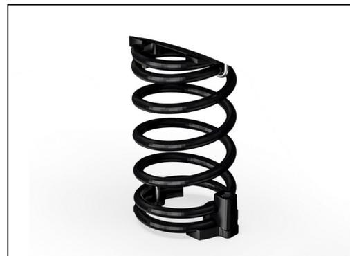
Los muelles KOMPAN están hechos de acero de resorte de alta calidad según EN10270. Los muelles se limpian mediante fosfatación antes de pintarlos con una imprimación epoxi y un recubrimiento de poliéster en polvo como acabado superior. Los muelles se fijan mediante accesorios anti-pellizcos únicos para máxima seguridad y larga vida útil.
