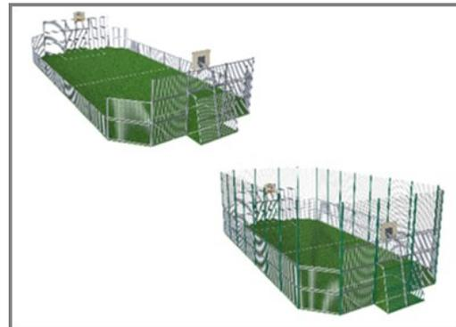
Die Höhe der Pfosten oberhalb des Untergrundes kann zwischen 1, 2, 3 & 5 m variieren. Bei der Oberflächenmontage hat das Fundament eine Größe von 200 x 200 x 10 mm. Bei der Bodenmontage befinden sich 45 cm der Pfosten der Seiten-Banden im Boden und 90 cm der Tor-Banden.
