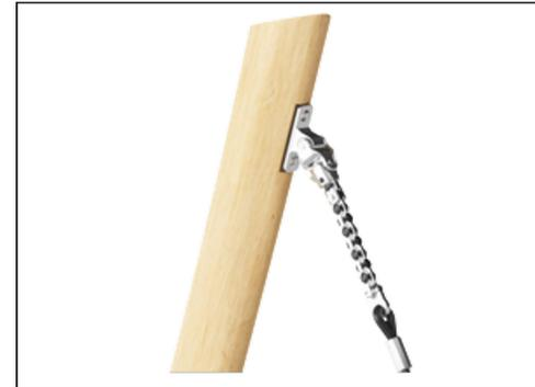
Die Schaukelaufhängungen sind aus Edelstahlbügeln gefertigt und können über zwei Achsen bewegt werden. Die Flanschlager sind mit Silikon angereichert, um die Aufhängung wartungsfrei zu machen. Die Verbindung zum Seil wird mit einer Edelstahlkette hergestellt.
