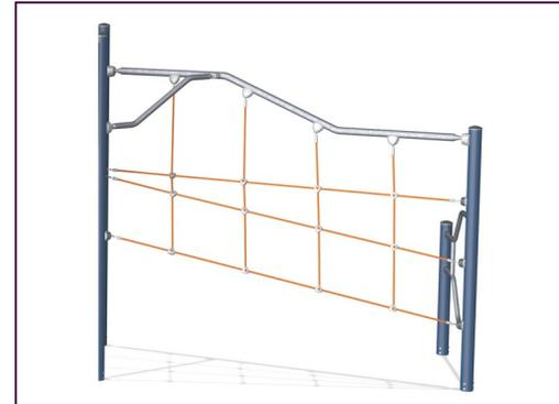
Die ELEMENTS™ Seile verfügen über sechslitzige Stahl Drahtseile, die mit einem Stahlkern versehen sind. Jede Litze ist mit PES-Garn umwickelt, das aus +95 % Post-Consumer-Material besteht. Das Garn wird induktiv auf jede einzelne Litze aufgeschmolzen, was die Seile äusserst beständig gegenüber Abnutzung und Vandalismus macht.
