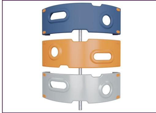
Die dargestellten Kletterelemente sind in einem Stück formgepresst, bestehen aus 33 % recyceltem Post-Consumer-Material und besitzen eine Mindeststärke von 5 mm. Die Kletterelemente sind aus recycelbarem PE mit einer hohen Verschleissfestigkeit und Temperaturbeständigkeit gefertigt. So sind sie äusserst vandalismusbeständig in allen Aussenumgebungen.
