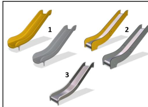
Rutschen sind in drei Materialausführungen erhältlich: gegossene, stückgeformte PE-Rutschen, Kombination aus EcoCore™ Rutsche und Edelstahlbett (t = 2 mm) oder Edelstahlrutsche (AISI 304, t = 2 mm).
