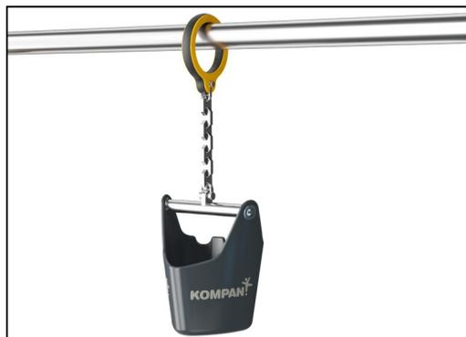
Der Sandeimer wird in einem Stück aus geformtem PE hergestellt. Das PE ist mit 33 % Post-Consumer-Materialien in verschiedenen Farben mit einer Wandstärke von mindestens 5 mm hergestellt. Das Material entspricht der europäischen Norm EN 71-3 und ist auf UV-Stabilität getestet.
