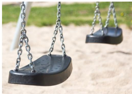
I seggiolini standard delle altalene KOMPAN sono progettati per garantire la massima sicurezza e durata. La seduta a due componenti con anima interna in PP e gomma esterna viene prodotta con un'unica operazione. I sedili sono disponibili con catene a battente in acciaio zincato a caldo, o acciaio inossidabile per tutte le altezze delle altalene.
