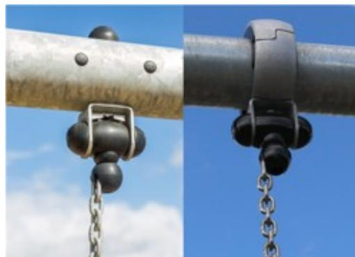
Le staffe a battente sono realizzate in nylon di alta qualità stabilizzato ai raggi UV (PA6) con cuscinetti a sfera integrati sigillati a vita. Le catene regolabili in altezza sono fissate da un gancio in acciaio inossidabile con bullone a occhio di serpente antifurto in un alloggiamento anti-rotazione. Tutti i sedili con due fissaggi a catena sono disponibili con sospensione standard o anti-avvolgimento.
