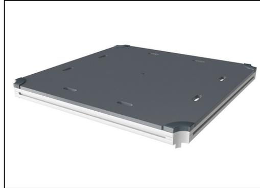
Alle Bodenplatten werden von einzigartig gestalteten kohlenstoffarm gefertigten Aluminiumprofilen und mehreren Befestigungen getragen. Die grau gefärbten, spritzgussgeformten Bodenplatten bestehen zu 75 % aus Post-Consumer-Abfällen (PP-Material) und haben ein rutschfestes Muster und eine strukturierte Oberfläche.
