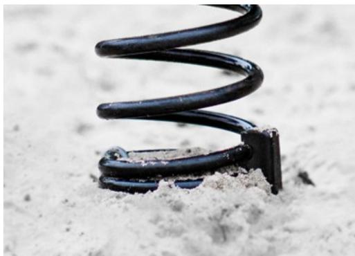
KOMPAN 弹簧由符合 EN10270 的优质弹簧钢制成。弹簧通过磷化处理进行清洁，然后将其涂上环氧底漆和聚酯粉末涂料作为上光油。弹簧通过独特的防夹配件固定，以实现最大的安全性和较长的使用寿命。
