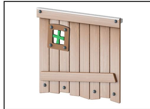
Holzversion aus FSC®-zertifiziertem (FSC®C004450) Kiefernholz mit druckimprägnierter Grundbehandlung und braun lackierter Oberfläche. Vertikale Bretter und obere Enden sind durch ein einzigartiges Aluminiumprofil geschützt, das eine hohe Haltbarkeit im Aussenbereich gewährleistet.
