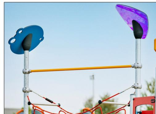
Le cadre porteur est fait d'acier carbon de Ø48,3mm x 4 mm, avec une surface galvanisée par immersion à chaud conforme à la norme ISO1461, et un revêtement de poudre anti corrosion de classe C3 selon la norme ISO12944-2. La teneur en plomb des surfaces est inférieure à 90 ppm.
