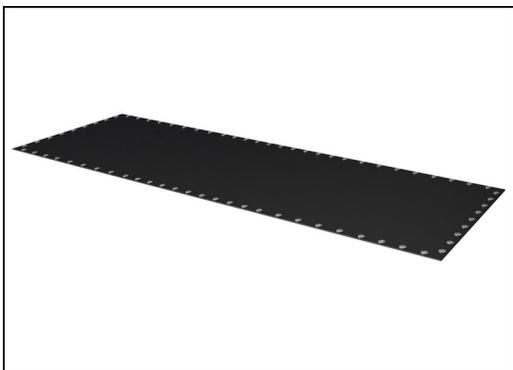
Le membrane di salto sono realizzate con nastro trasportatore EP Etilene-Propilene di spessore 6,0 mm con carcassa in tessuto di poliammide poliesteri. I fissaggi a molla sono rinforzati con boccole in acciaio e rondelle su entrambi i lati. La membrana è resistente all'ozono e dotata di 5 fori di drenaggio dell'acqua posizionati al centro.
