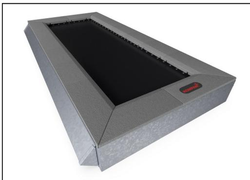
Tutti i componenti in acciaio sono realizzati in acciaio al carbonio S235 con uno spessore di 3 mm. I pannelli laterali, le pareti di supporto per il telaio superiore, le piastre piegate con SBR e le piastre piatte per il rivestimento in situ sono zincate a caldo. I due pannelli laterali lunghi sono elettrozincati e verniciati a polvere.
