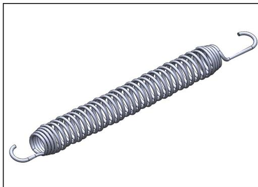
Tutte le 72 molle sono realizzate in acciaio inossidabile per garantire durata ed eccellente resistenza alla corrosione. Il filo di acciaio ha uno spessore di 3,2 mm e gli ultimi cinque avvolgimenti sono a forma di cono per garantire una lunga durata del trampolino.
