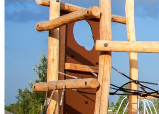
Holz-Kletterwand. Die Kletterwände bestehen aus 21,5 mm dicken Siebträger Platten aus Erlen- und Kiefernholz. Beide Seiten sind mit 2 Lagen Phenolfilm mit Antirutsch-Beschichtung bedeckt. Alle Schnittkanten sind mit Farbe versiegelt, um eine lange Lebensdauer zu gewährleisten.
