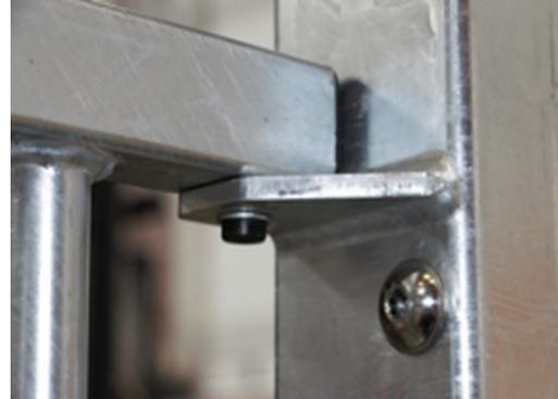
Touts les composants en acier sont fabriqués en acier carbone, soudés en conformité avec la norme EN ISO 5817 et galvanisés à chaud (HDG) selon la norme ISO1461. Ce processus assure une bonne protection en toutes circonstances.
