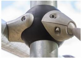
设计独特的 GALAXY 连接球由铝制的内部圆形芯制成,周围由硬质 PP 外壳和软性 TPV 橡胶外层包围。柔性无铅铝连接部件允许以可变角度安装
