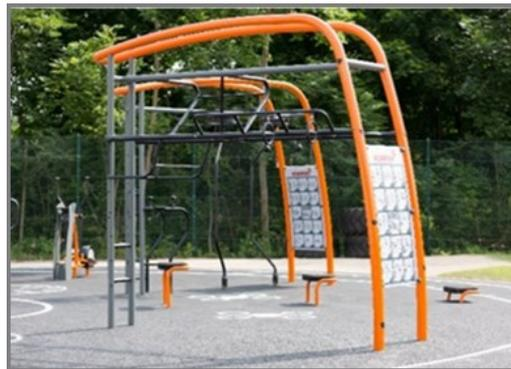
Um die Unversehrtheit des Hauptrahmens zu gewährleisten, werden die orangefarbenen Hauptpfosten aus Stahlpfosten  $\varnothing 101,6 \times 3 \text{ mm}$  hergestellt, die feuerverzinkt und pulverbeschichtet in Orange (RAL2010) sind. Die Stützpfeiler erhalten die gleiche Oberflächenbehandlung und bestehen aus Stahlrohren  $\varnothing 76,1 \times 3,6 \text{ mm}$ , die grau (RAL7012) pulverbeschichtet sind.
