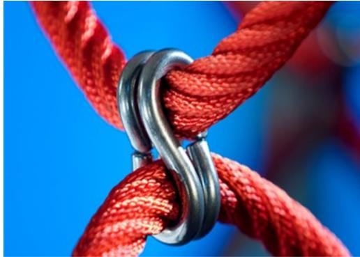
Die Corocord-S-Klemmen sind universale Verbindungselemente aus rostfreiem Edelstahl mit einem Durchmesser von 8 mm. Die Klemmenden sind abgerundet und das gesamte Bauteil wird mit hydraulischen Spezialwerkzeugen auf das Seil gepresst. Daher können die Klemmen mit herkömmlichen Werkzeugen nicht entfernt werden.
