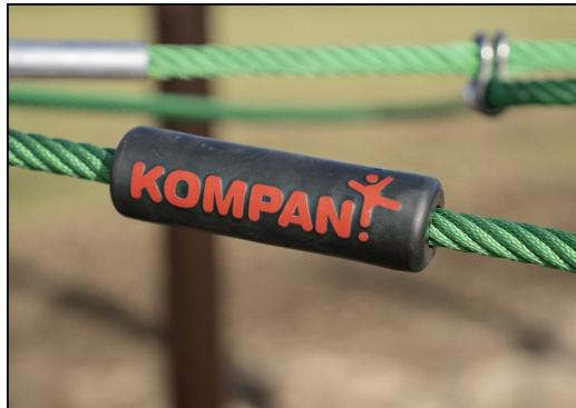
绳索由防紫外线的 PES 绳股制成，并带有内部钢缆增强件。聚酯包裹的绳股经过感应处理，熔化到每根单独的丝束上，以获得优异的耐磨性和抗撕裂性。
