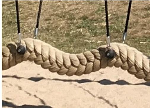
La corde du pendule est fabriquée en polypropylène (PP) dans le style noix de coco, avec une forme carrée de 14 x 14 cm. Les extrémités de la Corde coco sont fermées par une pince en acier et scellées par une gaine thermotractable. Les 10 derniers centimètres des extrémités des cordes sont laissés libres pour former un amortisseur afin de répondre aux normes de sécurité internationales.
