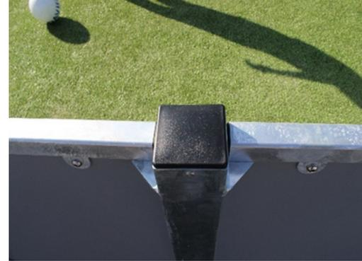
Los postes están hechos de un perfil de 80 x 80 x 3 mm con bridas soldadas horizontalmente de 6 mm. Esto permitirá una instalación fácil y una construcción sólida. Los postes de polietileno de baja densidad están unidos con remaches ciegos.
