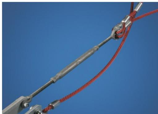
Le funi portanti delle Spacenet sono dotate di una funzione di sicurezza aggiuntiva: in caso di rottura dei collegamenti principali, la fune di sicurezza impedisce il collasso della struttura.
