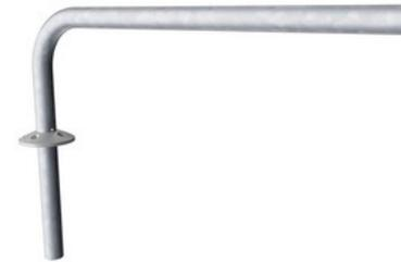
扶手是在练习时握着，由 Ø38mm 的热浸镀锌钢制成。大直径可以很好的用来握住和支持手腕。扶手距 HPL 板顶部有 940mm。两边距离是 900mm。
