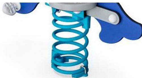
Les ressorts KOMPAN sont fabriqués en acier de haute qualité selon la norme EN 10270. Les ressorts sont nettoyés par phosphatation, avant d'être peints avec une amorce époxy et un revêtement thermolaqué de polyester en guise de finition. Les ressorts sont fixés par des raccords anti-pincement uniques pour une sécurité maximale et une longue durée de vie.
