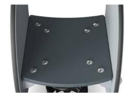
Der Sitz besteht aus einer Ekogrip® Platte, die aus einer 15 mm dickem PE -Fläche und einer 3 mm dicken Gummibeschichtung gefertigt ist, welche für einen Anti-Rutsch-Effekt sorgt.
