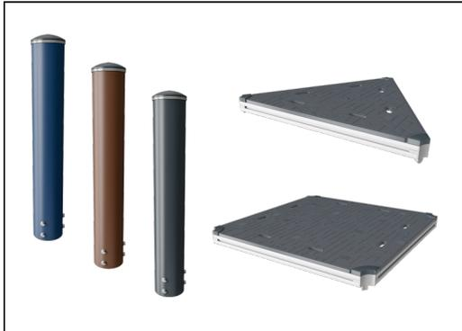
Los postes principales están fabricados en acero pregalvanizado de alta calidad con un acabado superior en polvo. Las tapas de los postes se cierran con tapones de nylon estabilizado a los rayos UV (PA6). Las cubiertas moldeadas de color gris están fabricadas con un 75% de material de PP de desecho oceánico postconsumo con una superficie antideslizante y texturizada. Todas las cubiertas se apoyan en perfiles de aluminio de bajo carbono de diseño exclusivo con múltiples opciones de fijación.
