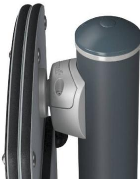
Die Steckverbinder bestehen aus Aluminiumdruckguss, der speziell für den Aussenbereich legiert ist und einen Bleigehalt von unter 100 ppm aufweist. Die Verbinder werden mit Schrauben aus rostfreiem Stahl an den Pfosten befestigt und sind durch speziell entwickelte Zinkscheiben gut gegen Korrosion geschützt. Extrem stark und ohne Korrosionserscheinungen. .
