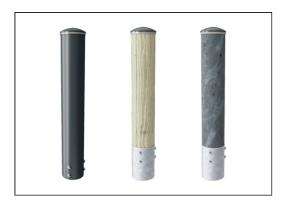
Hauptpfosten mit Verankerung aus feuerverzinktem Stahl sind in verschiedenen Materialien erhältlich: aus kesseldruckimprägniertem Kiefernholz; aus Stahl innen und außen bandverzinkt mit pulverbeschichteter Oberfläche; aus bleifreiem Aluminium mit farbig eloxierter Oberfläche; TexMade Pfosten aus 95% recyceltem PE und Textilabfällen.
