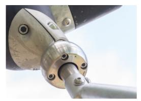
Lagersysteme in wartungsfreier Konstruktion. Alle Stahllager sind vollständig geschlossen und dauergeschmiert.
