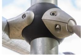
Die speziell entwickelte Galaxy Verbindungskugel besteht aus einem runden Aluminiumkern, der von einer mit TPV gummierten Kunststoff-Schale (PP) umgeben ist. Die beweglichen Verbindungselemente aus bleifreiem Aluminium ermöglichen eine flexible Montage.
