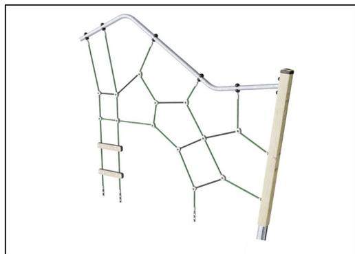
Les filets de corde sont constitués de cordes PES simples tressées de 16 mm. Le PES a une résistance élevée avec une excellente résistance à l'abrasion et aux rayons UV. Les boucles de corde sont assemblées par des connecteurs en aluminium.
