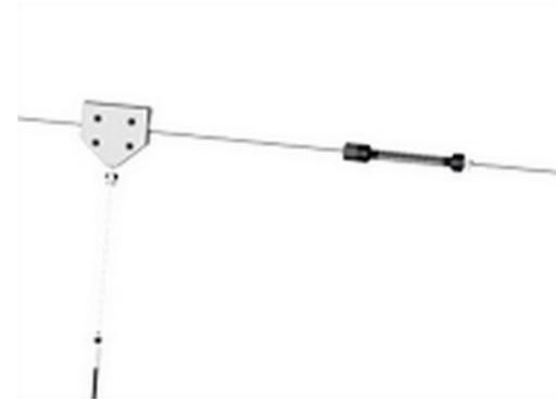
El cable de acero de alta calidad con un diámetro de 12 mm está diseñado para un uso intensivo del cable por muchos años. El punto de partida se indica mediante una perilla. En el punto de parada hay un dispositivo de resorte diseñado especialmente que garantiza una parada más suave del extractor.
