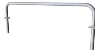
Les balustrades qui servent de poignées pendant les exercices sont faites d'acier galvanisé par immersion à chaud de 38 mm, un diamètre idéal pour une bonne prise en main et pour soutenir les poignets. Leur hauteur est de 940 mm à partir du haut de la plaque HPL. La distance entre les balustrades est de 900 mm.
