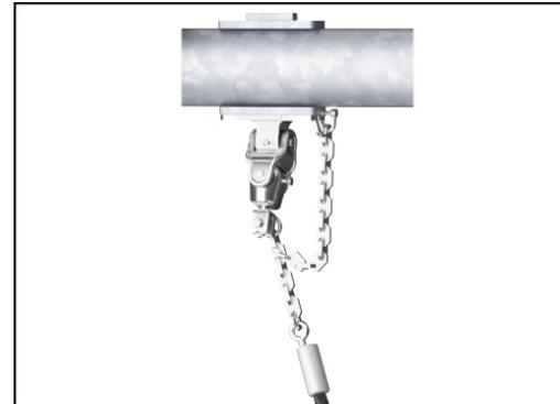
Crochets de suspension KOMPAN robustes en acier inoxydable avec fonction anti-torsion. Les cintres sont fixés à la traverse sur un support soudé avec deux boulons, les roulements sont intégrés avec du lubrifiant silicone et ne nécessitent aucune lubrification supplémentaire.
