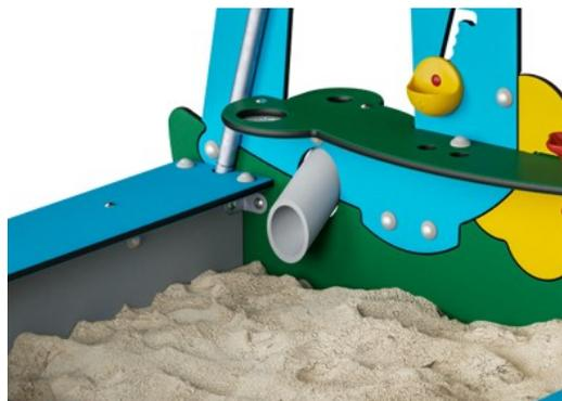
Das PE-Sandrohr gibt es in verschiedenen Farben. Es wird zu 33 % aus Post-Consumer-Material in einem Stück mit einer Wandstärke von mindestens 5 mm hergestellt. Das Material entspricht der europäischen Norm EN 71-3 und ist auf UV-Stabilität getestet.
