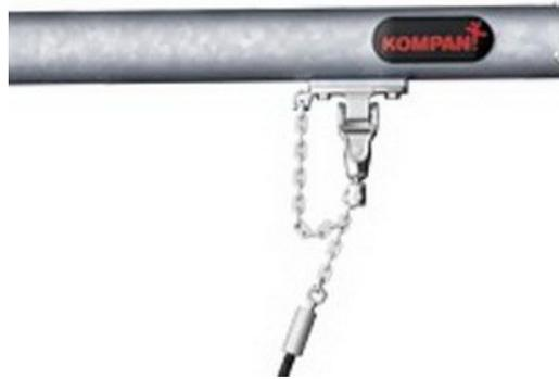
KOMPAN 设计的重载型不锈钢秋千吊架具有防扭曲功能。吊架通过两个螺栓固定在焊接支架上的横梁上。轴承内嵌硅酮润滑剂，无需进一步润滑。
