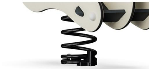
Les ressorts KOMPAN sont fabriqués en acier de haute qualité selon la norme EN 10270. Les ressorts sont nettoyés par phosphatation, avant d'être peints avec une amorce époxy et un revêtement thermolaqué de polyester en guise de finition. Les ressorts sont fixés par des raccords anti-pincement uniques pour une sécurité maximale et une longue durée de vie.
