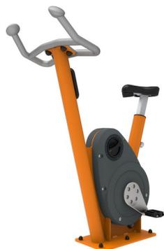
Le tube de base du cadre est fabriqué en tube d'acier S235 galvanisé à chaud avec les dimensions suivantes 76,1x3,6mm et avec un revêtement en poudre de classe de corrosion C3 selon ISO12944-2.
