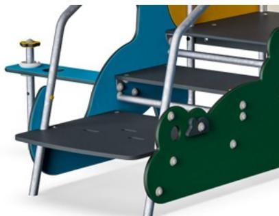
Tous les planchers sont fabriqués en HPL (stratifié à haute pression) d'une épaisseur de 17,8 mm et une surface antidérapante respectant la norme EN 438-6. KOMPAN HPL présente une grande résistance à l'usure, ce qui lui assure une longue durée de vie dans tous les climats.
