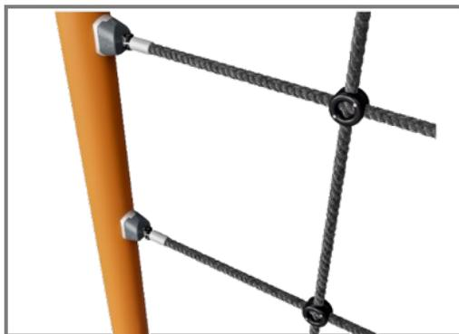
Le corde Corocord da 16 mm sono di tipo "Hercules" con fili di acciaio a quattro fili zincati e un nucleo di filo di acciaio. Ogni filo è strettamente avvolto con filo PES, che viene fuso su ogni singolo filo. Le corde sono altamente resistenti all'usura e agli atti vandalici e possono essere sostituite sul posto, se necessario.
